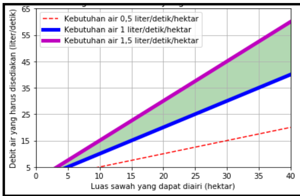
Gambar II. 13. Grafik Hubungan Antara Luas Sawah yang Dapat Diairi Dam Parit Dengan Debit Masuk yang Harus Disediakan
